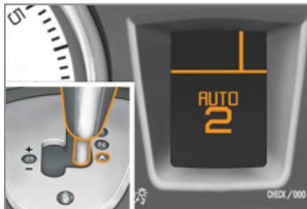
Le rapport de vitesse ou le mode de conduite sélectionné apparaît dans l'afficheur du combiné.
