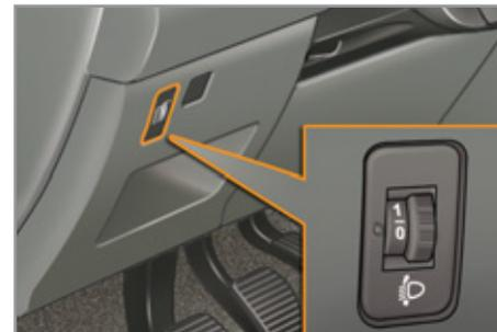
Pour ne pas gêner les autres usagers de la route, les projecteurs à lampes halogènes doivent être réglés en hauteur, en fonction de la charge du véhicule.
