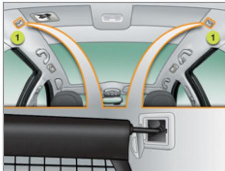
**i** Au moment de positionner le filet, vérifiez que les boucles des sangles sont visibles depuis le coffre ; cela vous facilitera leur manipulation pour les détendre ou les tendre.
