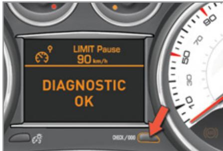
☞ Moteur tournant, pour lancer un check manuel, effectuez un appui bref sur le bouton «CHECK/000» du combiné.
