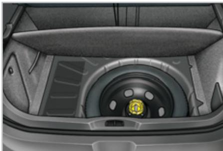
La roue de secours est installée dans le coffre sous le plancher.
