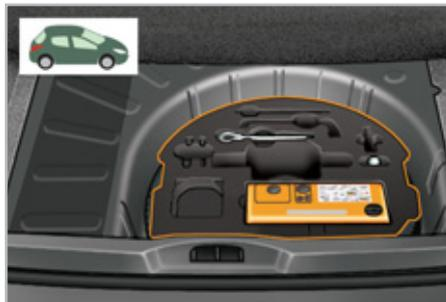
Ce kit est rangé dans le coffre sous le plancher. Il est installé dans la boîte à outils, située sous la boîte de rangement.
