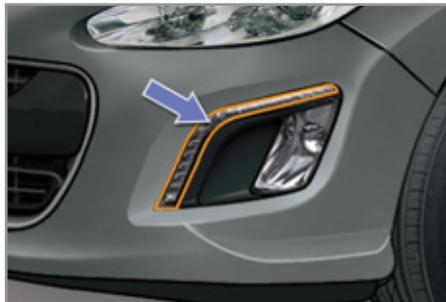
Pour le remplacement de ce type de lampe à diodes électroluminescentes, consultez le réseau PEUGEOT ou un atelier qualifié.
