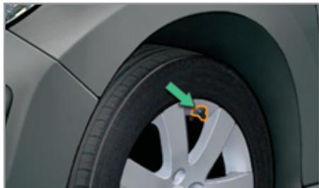
Des capteurs, montés dans chaque valve, déclenchent une alerte en cas de dysfonctionnement (vitesse supérieure à 20 km/h).
