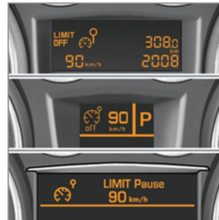
Le mode régulateur ou limiteur de vitesse apparaît dans le combiné quand celui-ci est sélectionné.
