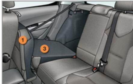
**!** Lors de la remise en place du siège arrière, faites attention à ne pas coincer les ceintures et à bien positionner leurs boucles.
