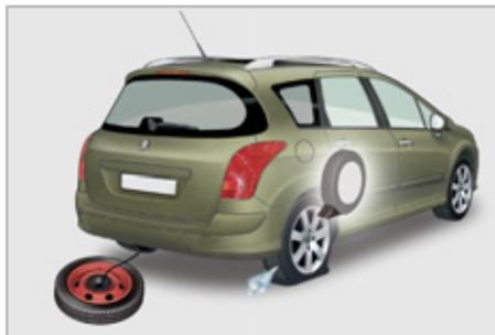
La roue de secours est maintenue par un système de treuil sous l'arrière du véhicule.
