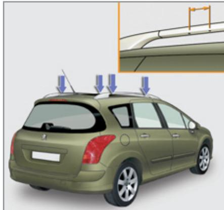
**i** Les barres de toit longitudinales ne sont pas démontables.
