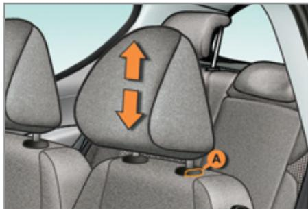
**!** L'appui-tête est muni d'une armature possédant un crantage qui interdit la descente de celui-ci ; ceci est un dispositif de sécurité en cas de choc.
